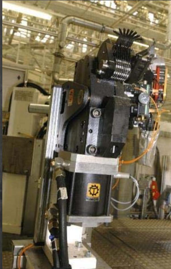
**Prägetechnik für die Bauteilkennzeichnung in der Karosseriefertigung**
