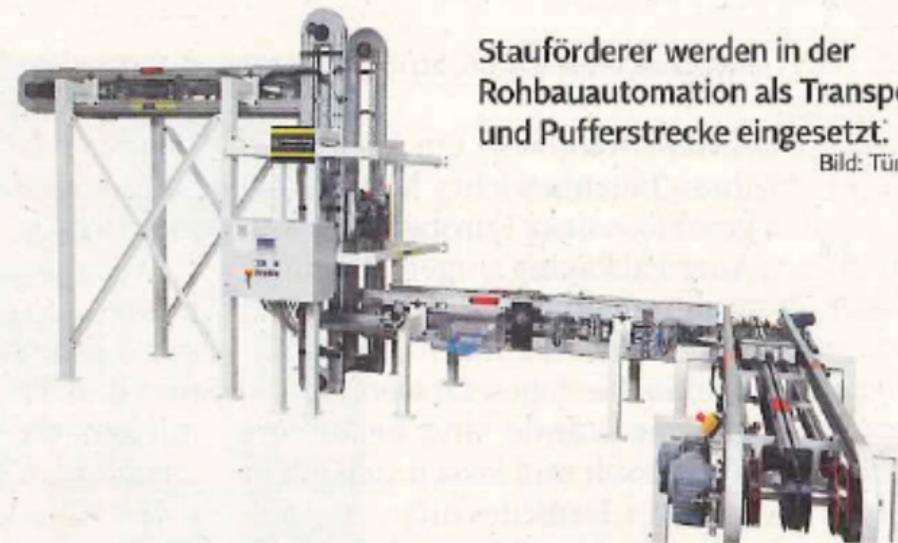
Stauförderer werden in der Rohbauautomation als Transport- und Pufferstrecke eingesetzt.
