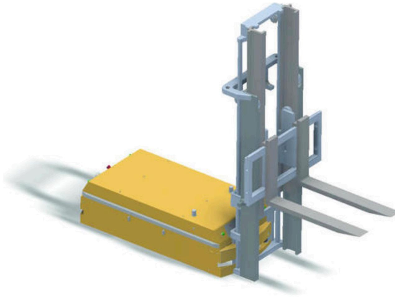
Automated Guided Vehicles (AGV) oder deutsch Fahrerlose Transportsysteme (FTS) können vielseitig eingesetzt werden und die unterschiedlichsten Transportaufgaben optimieren. Sie ermöglichen laut Tünkers eine höhere Flexibilität und Präzision, lassen sich in bestehenden Systemen nachrüsten und erfordern geringe bis keine Infrastrukturanpassungen.
