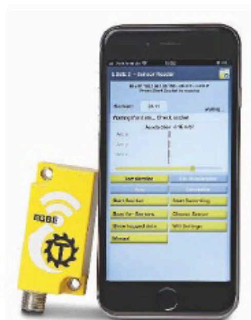
Tinkers baut Know-how über die Hardware hinaus auf. Der Sensor überträgt Maschinendaten in die Cloud. So lassen sich Werte via App auslesen und weiternutzen.
