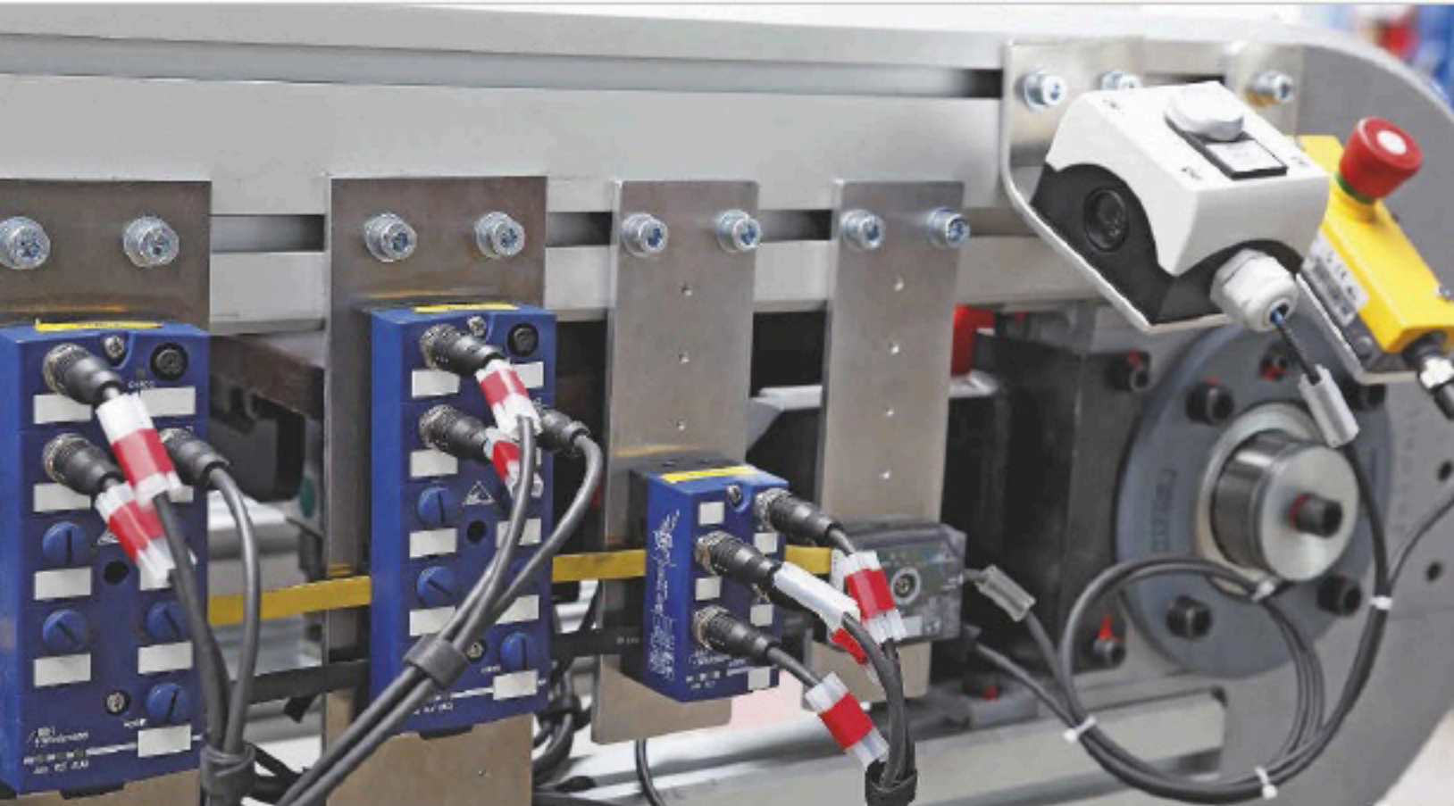
Mit Sensorintelligenz ausgestatteter Stauförderer: Die dadurch mögliche Zustandsüberwachung sorgt für Sicherheit und Effizienz. Bilder: Tinkers
