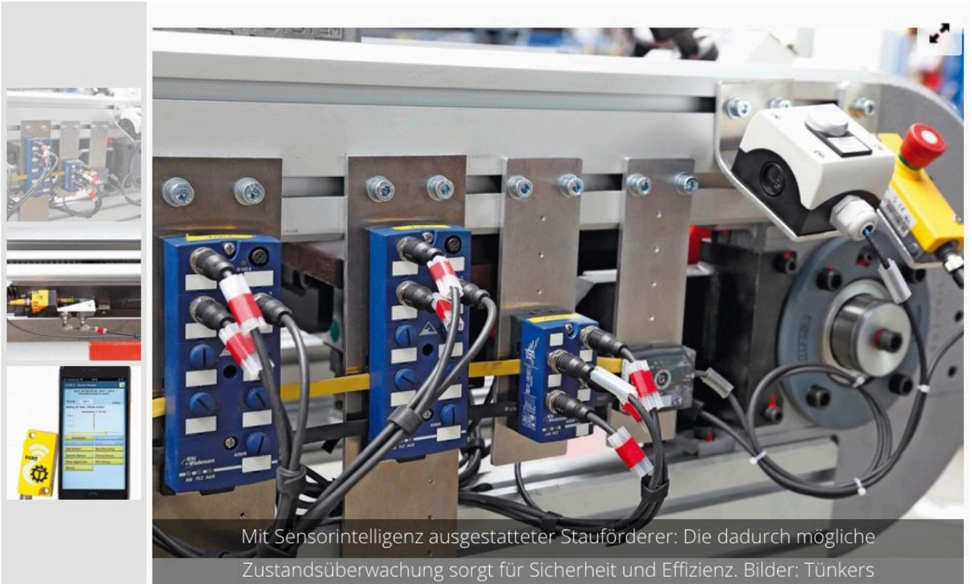
Mit Sensorintelligenz ausgestatteter Stauförderer: Die dadurch mögliche Zustandsüberwachung sorgt für Sicherheit und Effizienz. Bilder: Tünkers
