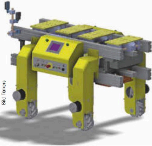
Fusion des Stauförderers mit einem AGV
