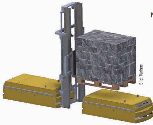
Flexible Aufnahme von Paletten, Werkstücken oder GLTs
