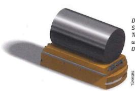
Das Coil-AGV ist als Sonderbauform für den Transport von Coils unterschiedlicher Durchmesser konzipiert.
