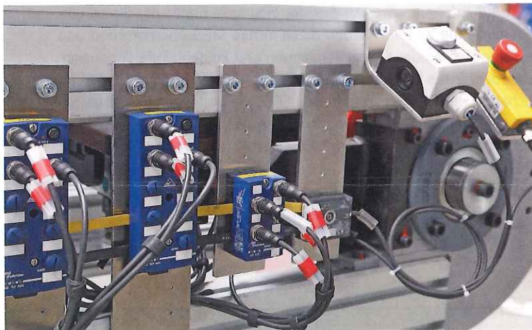
Der Smart Conveyor ist Standard-AFS-Stauförderer, der durch zusätzliche, redundante Sensorsysteme ausgerüstet wurde, um den aktuellen Zustand der Antriebs- und Steuereinheiten zu überwachen
