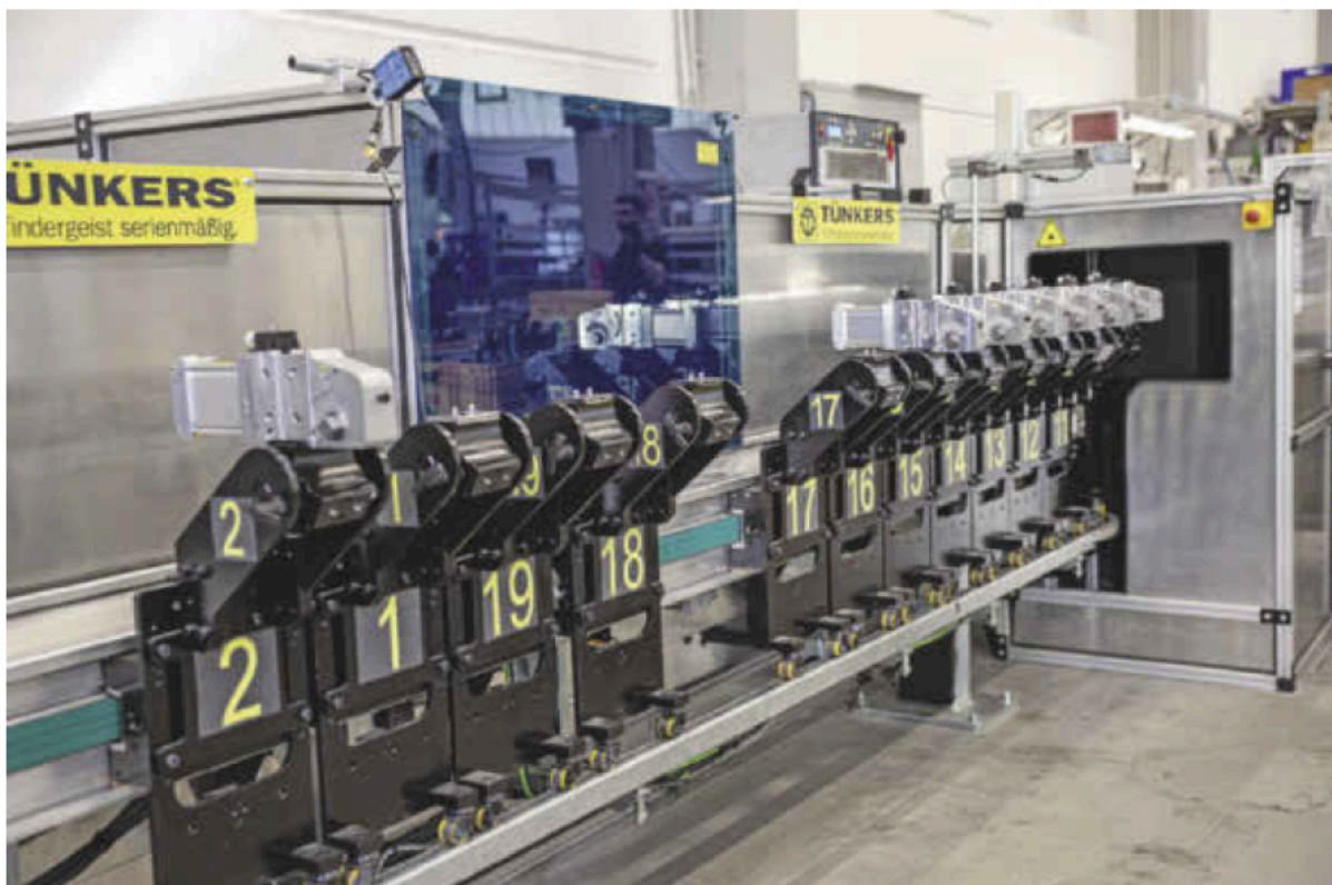
Über einen Stauförderer werden bei Tünkers in Ratingen Pneumatikspanner automatisiert einer Lasergravur zur Typenkennzeichnung zugeführt.
