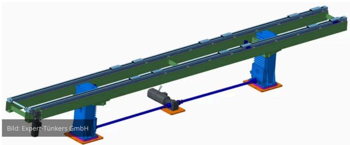
Hubshuttle-Systeme des Automationsspezialisten Expert-Tünkers transportieren Bauteile synchron und stoßfrei von Station zu Station. Die Bauteile werden synchron ausgehoben und nach dem Horizontalhub positionsgenau in der nächsten Station wieder abgelegt. Die Antriebe stammen aus dem bewährten Expert-Tünkers Sortiment. Der Vertikaltrieb erfolgt durch zwei oder mehrere Standard Walzenheber in Abhängigkeit von der Shuttlelänge. Als Antriebskonzept über
