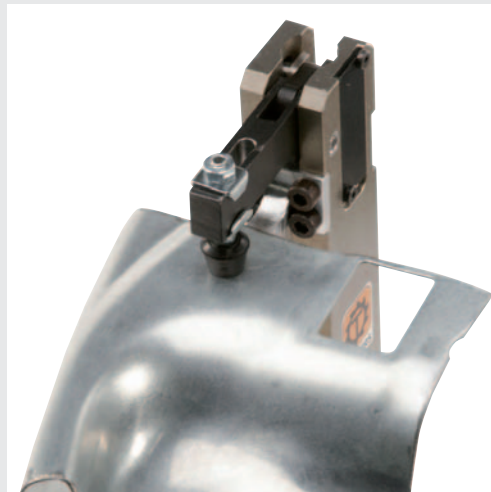
Spannen von Stahl / Aluminium-Bauteilen z. B. beim Schweißprozess
