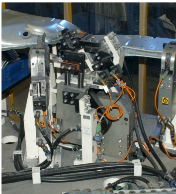
Bild 1 Verfahrzylinder mit Dualführungsachse in Schweissvorrichtung
