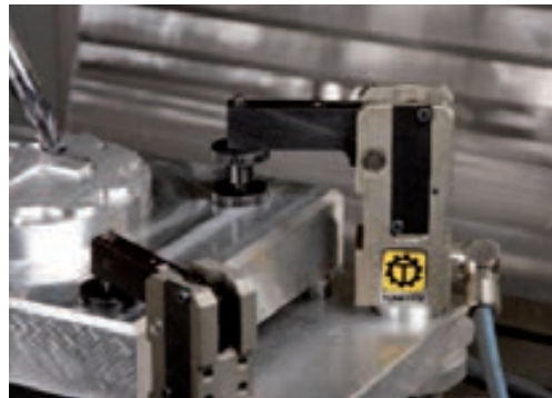
PKSG 20 in Gewindebauform für das Spannen eines Aluminiumbauteils während des Zerspanungsprozesses
